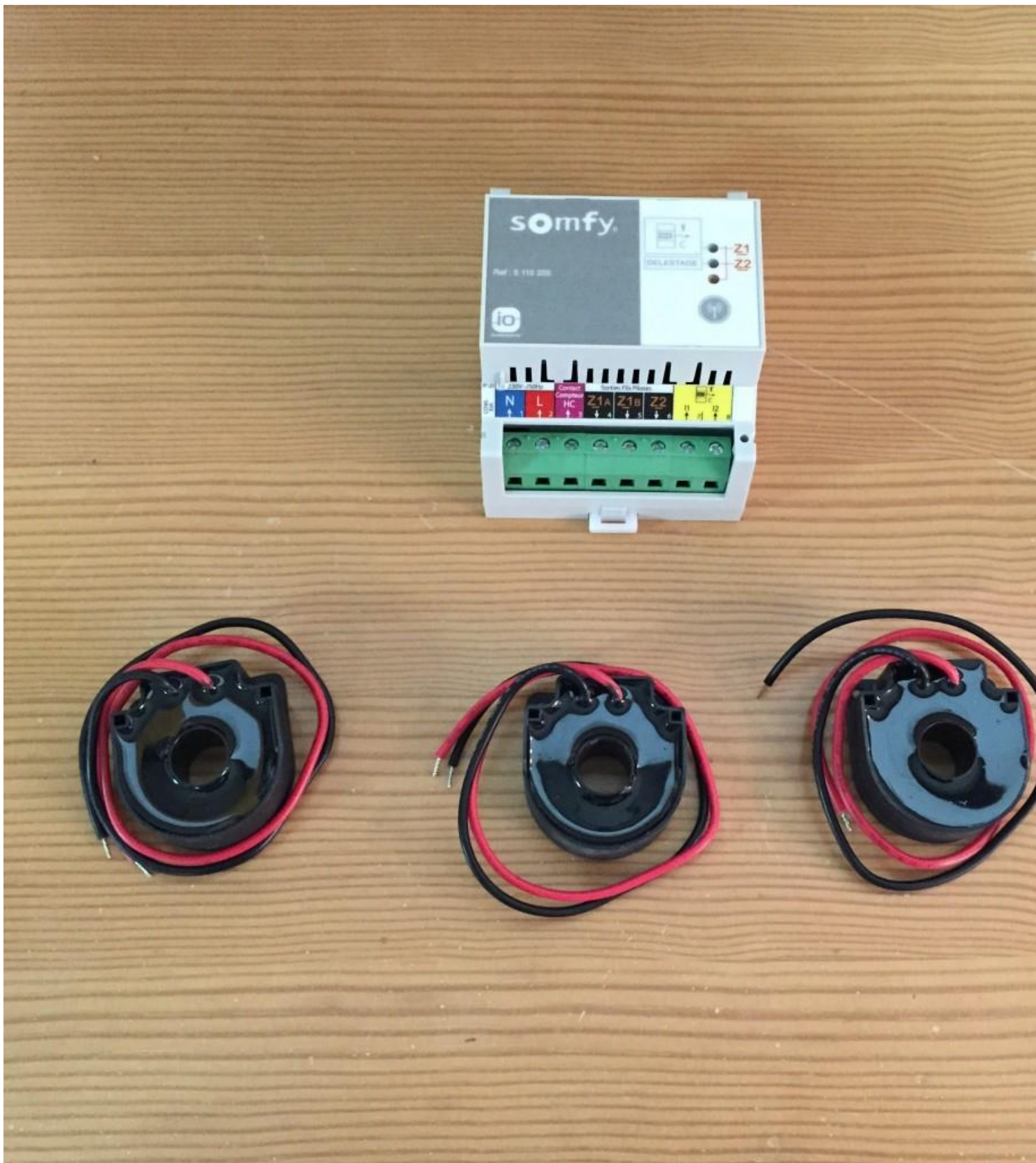
Le capteur de consommation et ses 3 tores d'intensité
