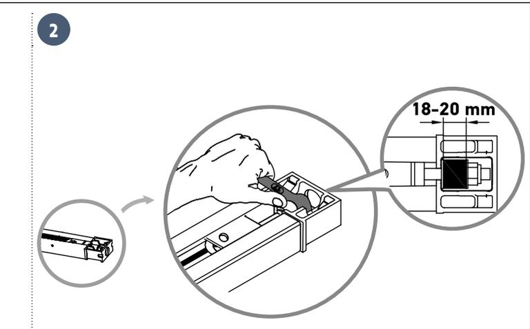
• Sur un rail en 3 parties, serrer l'écrou pour tendre la courroie. Le caoutchouc s'écrase. Pour une bonne tension de la courroie, le caoutchouc doit mesurer entre 18 et 20 mm.
