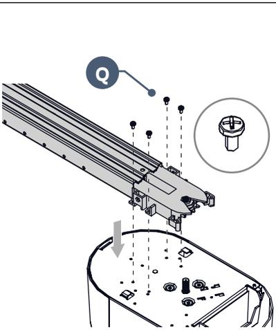
• Engager l'axe du moteur dans le pignon du rail puis fixer l'ensemble à l'aide des vis de la tête moteur
