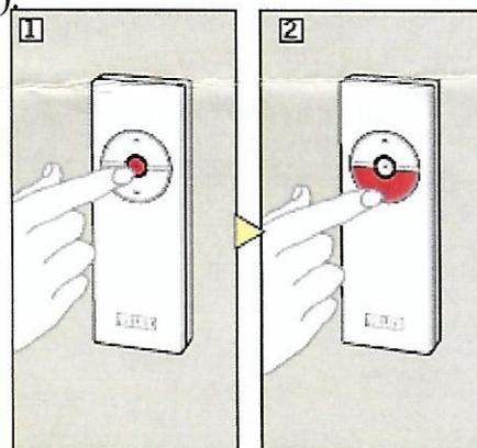
6. Remonter alors le volet par la flèche supérieure. Le volet est alors en fonction au travers de sa télécommande.
