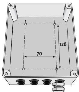
2 Wstawić część elektroniczną do obudowy skrzyni. W tym celu trzeba będzie użyć siły, żeby ją usytuować w odpowiednim miejscu. Następnie należy przymocować ją do obudowy za pomocą dołączonych do zestawu śrub.
