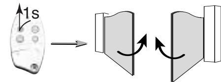
Aan het eind van deze 4 stappen gaat het lampje PROG uit, waarmee het einde van de geheugenopslagprocedure van de deurbeweging wordt aangegeven.
