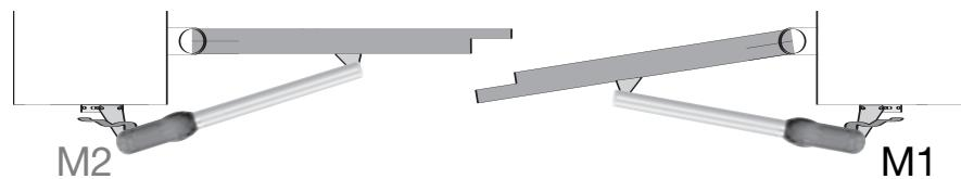
De cilinder M1 zet de **rechterdeur** in werking die als eerste geopend en als laatste gesloten.
