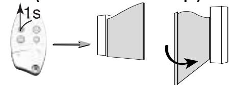
**Uw toegangshek is gereed om te functioneren. Druk op de knop van de afstandsbediening en uw toegangshek gaat automatisch open. Druk nog een keer en hij gaat achter u dicht.**
