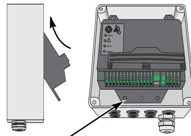
La caja se montará con el prensaestopas para abajo.
