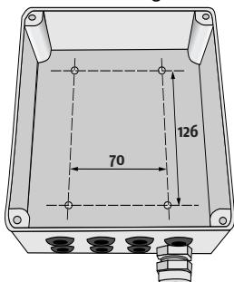
2 Colocar la electrónica en la caja. Habrá que forzar un poco para situarla. Sujetarla con el tornillo de sujeción que viene con el equipo:
