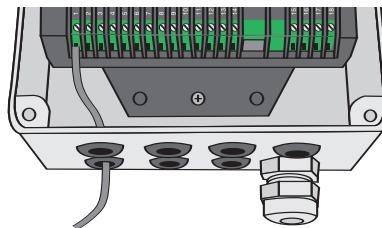
Conexión del cable de alimentación de la red.
