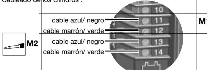
**! El cilindro M1 está conectado siempre entre los bornes 11 y 12.
