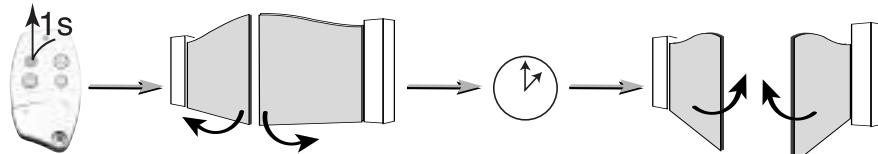
Se puede mantener la canela en posición abierta pulsando la tecla del mando a distancia durante la temporización.
