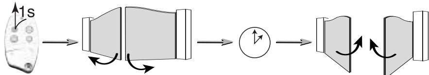
Het is mogelijk het toegangshek in de open stand te houden door een stopcommando te geven (opnieuw op de toets van de afstandsbediening drukken):
