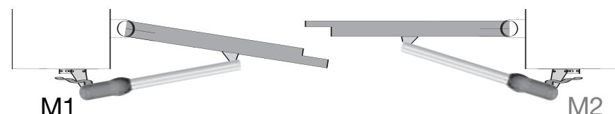
De cilinder M1 zet de **linkerdeur** in werking die als eerste geopend en als laatste gesloten wordt.
