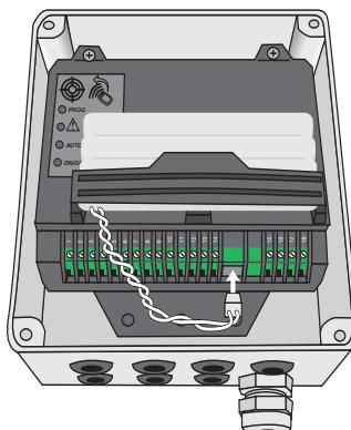
La batterie de secours assure le fonctionnement du portail en vitesse lente en cas de défaillance électrique.
