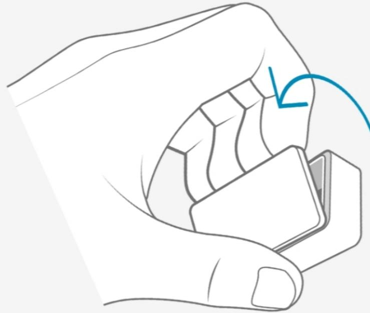
Ouvrez le capot de l'IntelliTAG, puis retirez la languette de la pile. Insérez la pile si nécessaire.
