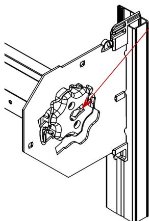
Dans le cas d'une motorisation type LS40 SOMFY, la sortie de câble électrique doit s'effectuer par le trou central de l'interface moteur LS/LT, et ce, afin d'éviter le pincement du câble dans la joue moteur.
