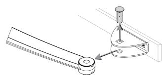
6 Percez les vantaux. Le diamètre de perçage est à définir en fonction du type de vis utilisées pour la fixation (voir page 7).
