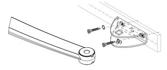
8 Ré-installez le bras dans la patte de fixation et remettez l'axe long (8).
