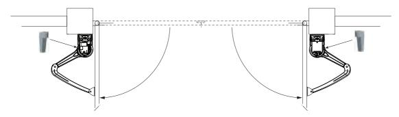
2 Placez la butée (9) dans l'encoche disponible la plus proche du pilier et côté opposé au vantail.
