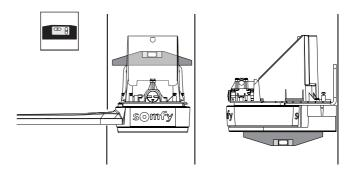
5 Fixez les moteurs avec les rondelles et les vis dans les trous du milieu et ceux du haut. Vissez les vis du bas.
