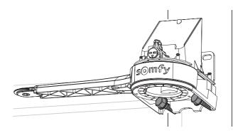
3 Sur la platine du moteur, dans le trou de fixation en haut à gauche, mettez dans l'ordre une rondelle, la cosse du fil de masse de l'électronique et une vis.
