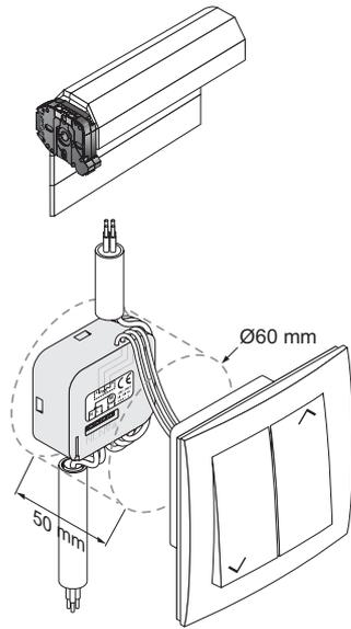
[1]. Dénudez les fils à l'aide du gabarit de dénudage en bas à gauche du micro-récepteur.
