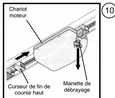
**! Vérifier le bon verrouillage en essayant de bouger la porte manuellement : elle doit être bloquée par le chariot moteur**
