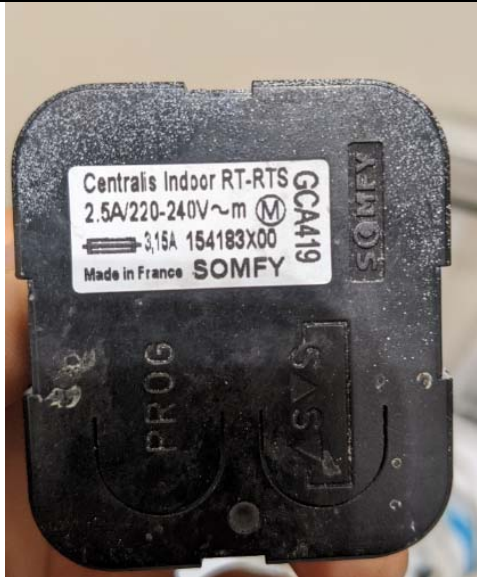
Récepteur SOMFY pour commander le moteur de volet roulant (vue de devant)
