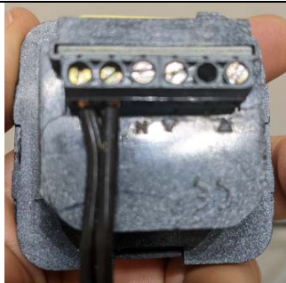
Récepteur SOMFY pour commander le moteur de volet roulant (vue de derrière)
