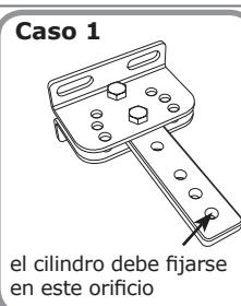
el cilindro debe fijarse en este orificio
