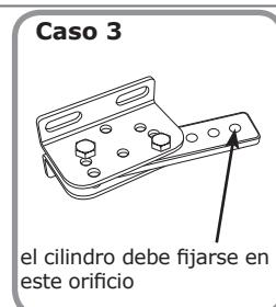
el cilindro debe fijarse en este orificio
