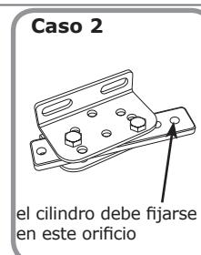
el cilindro debe fijarse en este orificio
